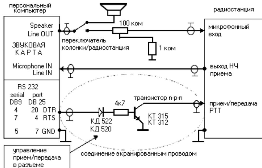
**Рис.9.1. Подключение «компьютер-трансивер»**
