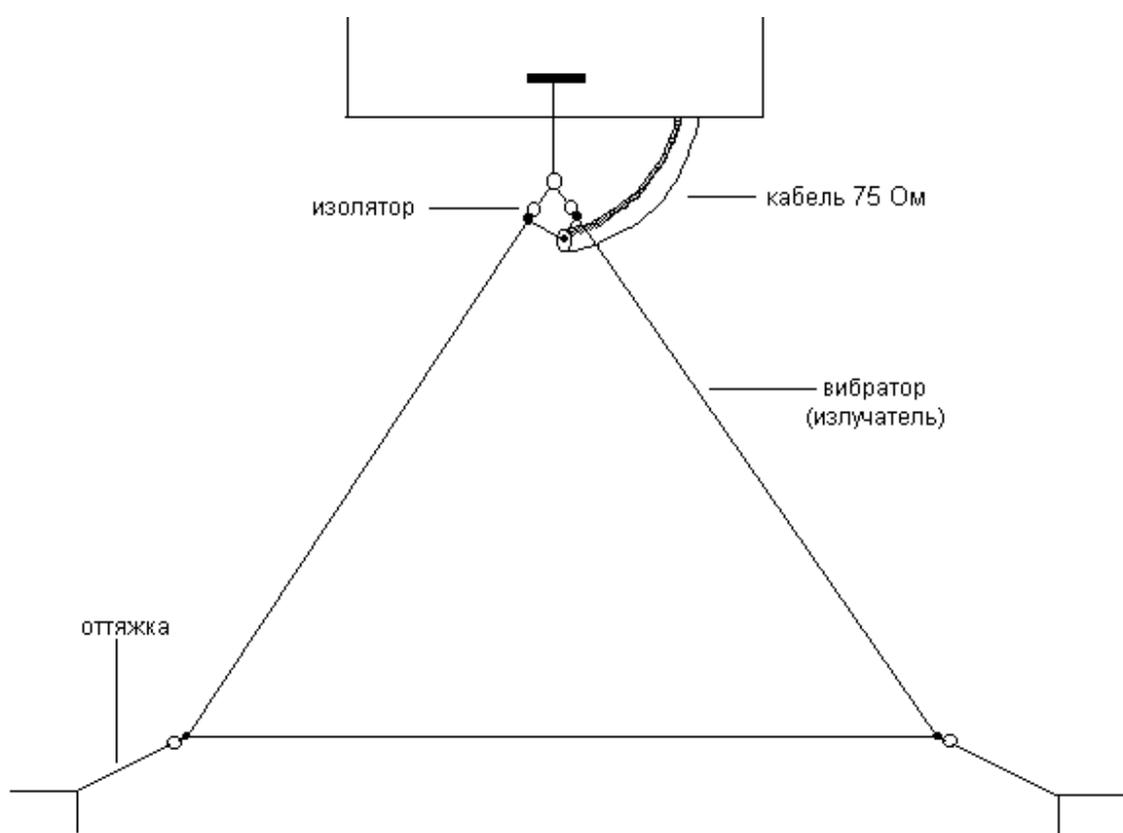
**Рис.2.13. Антенна «треугольник»**
