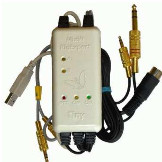
**Рис.9.2. Интерфейс «RigExpert Tiny»**
