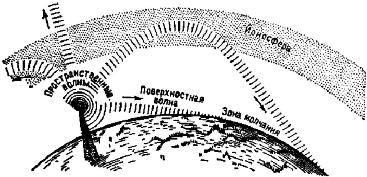
**Рис.2.1. Распространение радиоволн**
