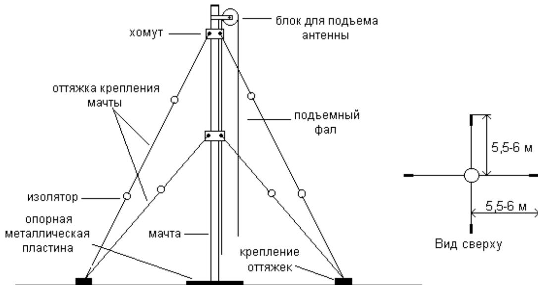
**Рис.2.9. Антенная мачта в развернутом виде**
