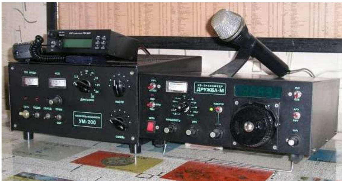
**Рис.2.6. Трансивер «Дружба-М» и усилитель мощности «УМ-200»**
