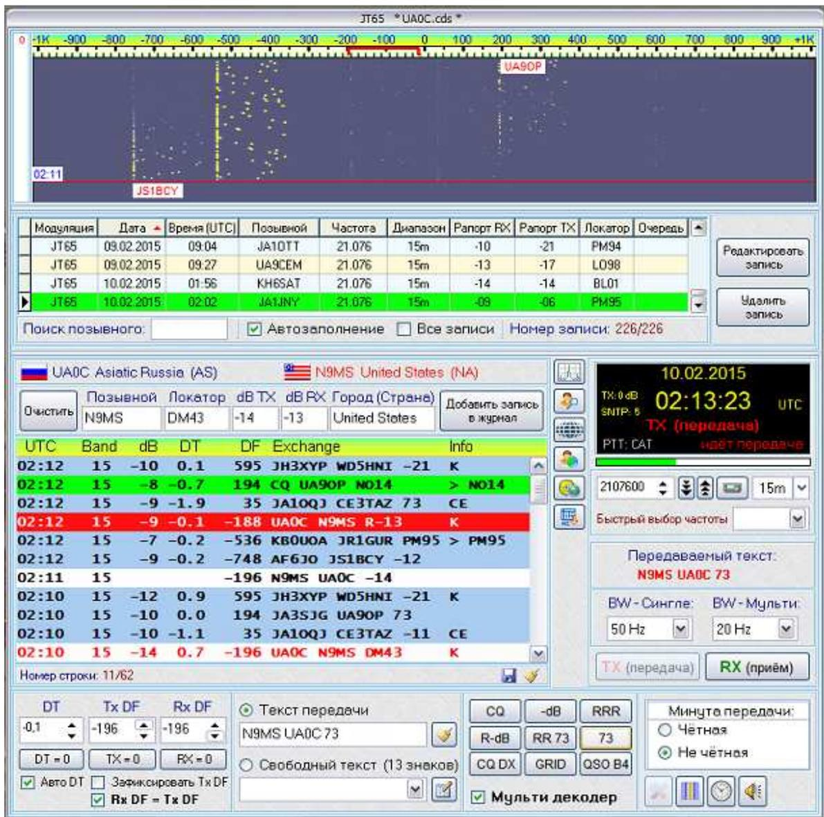
**Рис.9.5. Рабочее окно программы “KROT” для режима JT65A**
