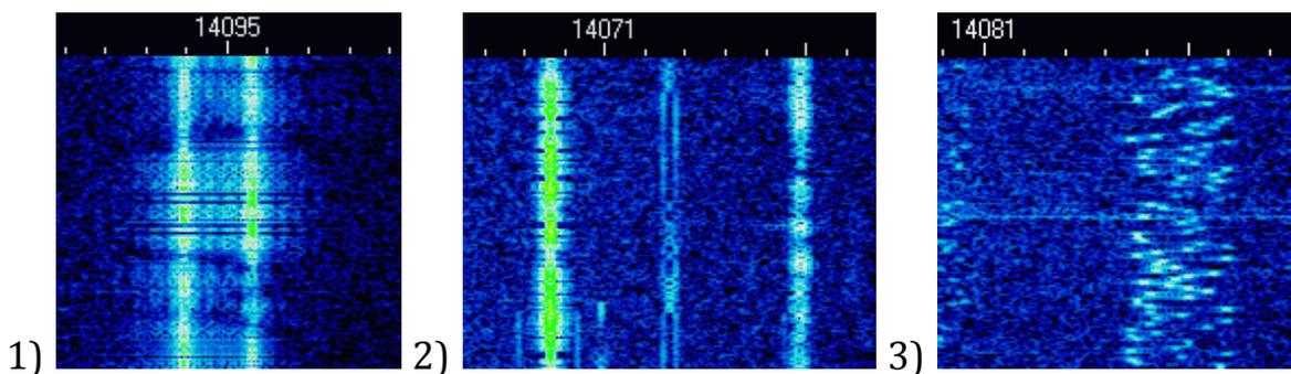
**Рис.9.3. Рисунок сигналов RTTY (1), PSK31 (2) и MFSK16 (3)**
