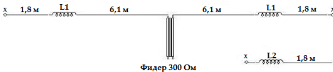
Рис. 2.17. Антенна «укороченный диполь»
